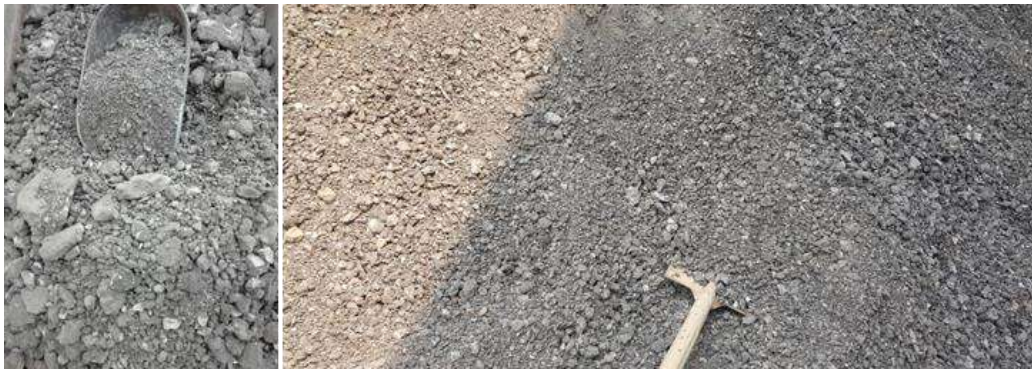
รูปที่ 2-2 วัสดุมวลรวม Recycled Asphalt Aggregate (RAP)
