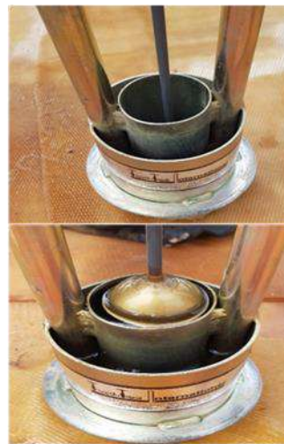
ดินโหล่ทางบดอัดปิดทับด้วยแผ่นยางพารา
