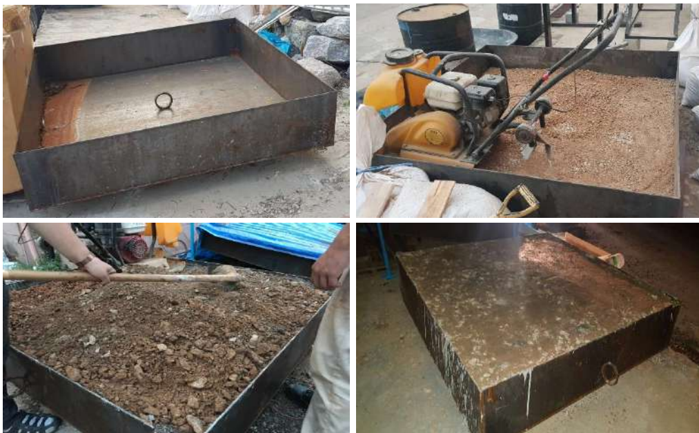
รูปที่ 2-63 การบดอัดวัสดุไหล่ทางในกระบะทดสอบ
