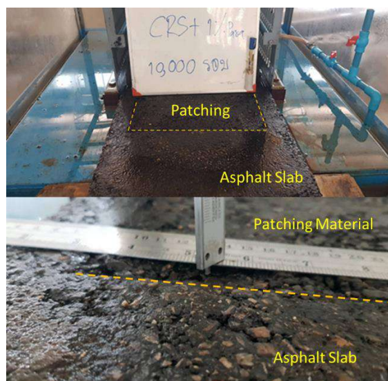
รูปที่ 2-58 การวัดค่าการยุบตัวของวัสดุปะซ่อมและประเมินสภาพพื้นผิว
