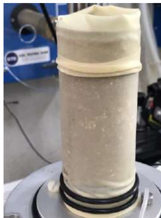
รูปที่ 2-36 ขั้นตอนการติดตั้งตัวอย่างการทดสอบ UU Triaxial Test
