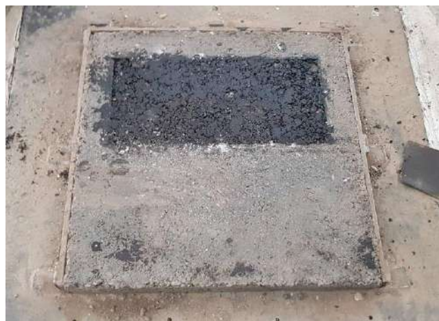
รูปที่ 2-56 ขั้นตอนการบดอัดแผ่นตัวอย่างวัสดุมวลรวมผสมเย็น
