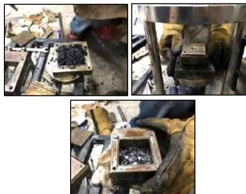
รูปที่ 2-29 ขั้นตอนการเตรียมตัวอย่างแอสฟัลต์คอนกรีต
