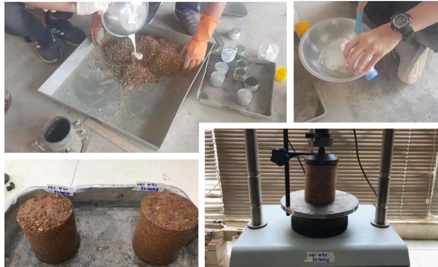
รูปที่ 2-16 แสดงภาพการผสมส่วนผสมและการทดสอบ UCS ของดินซีเมนต์ผสมยางพารา
