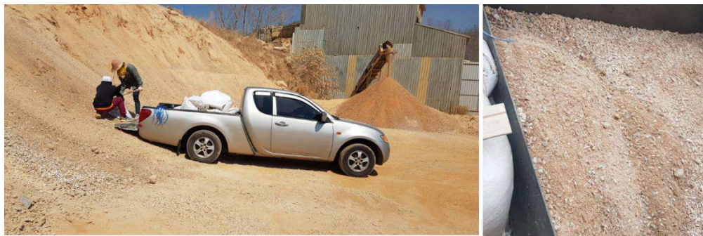
รูปที่ 2-5 วัสดุไหล่ทาง (หินปลายตะแกรง) ที่ใช้ในโครงการ
