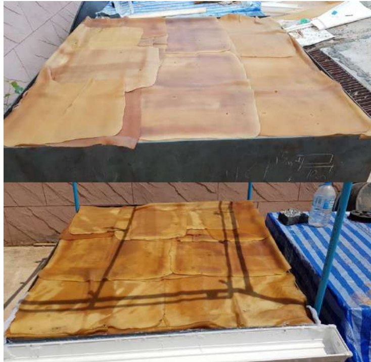
รูปที่ 2-66 ภาพแสดงกระบะจำลองลาดคันทางบดอัดปิดทับด้วยแผ่นยางพารารมควัน
