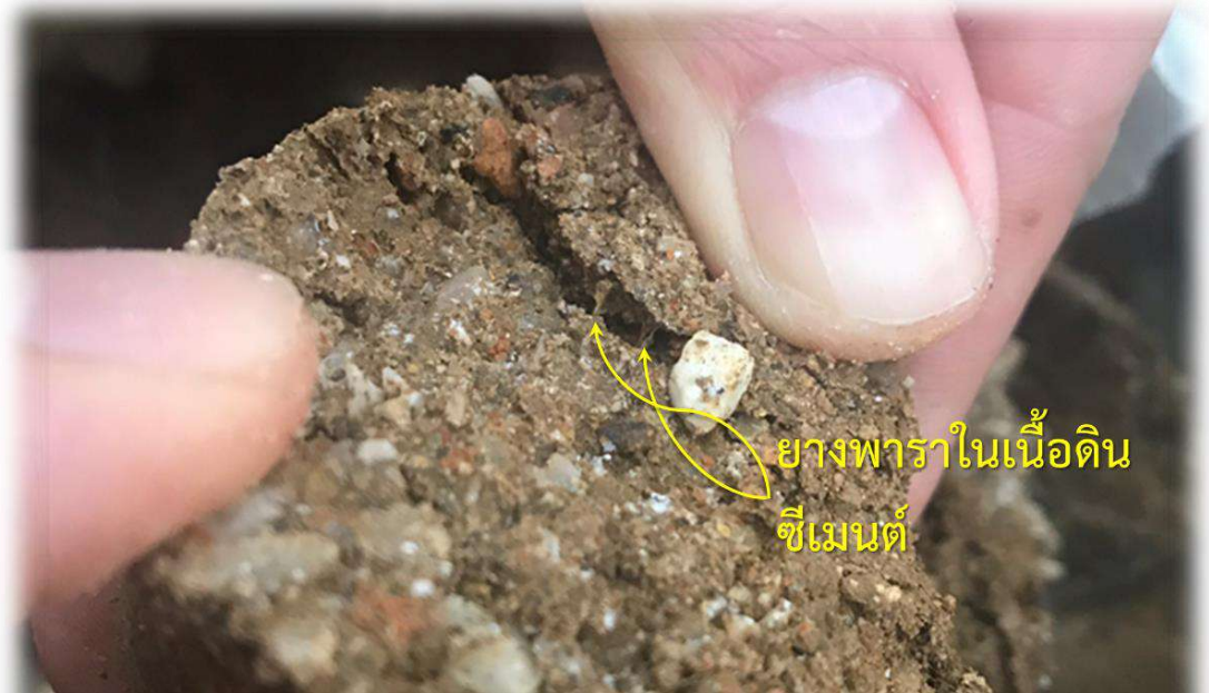
รูปที่ 2-52 ลักษณะของเนื้อยางพาราที่จับตัวอยู่ในเนื้อดินซีเมนต์ (ตัวอย่าง UU Triaxial Test)
