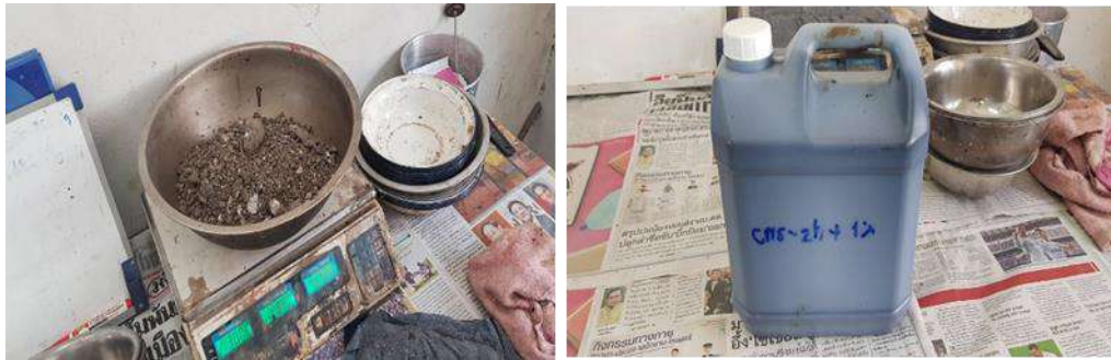
รูปที่ 2-55 ขั้นตอนการผสมวัสดุมวลรวม RAP กับแอสฟัลต์อิมัลชัน
