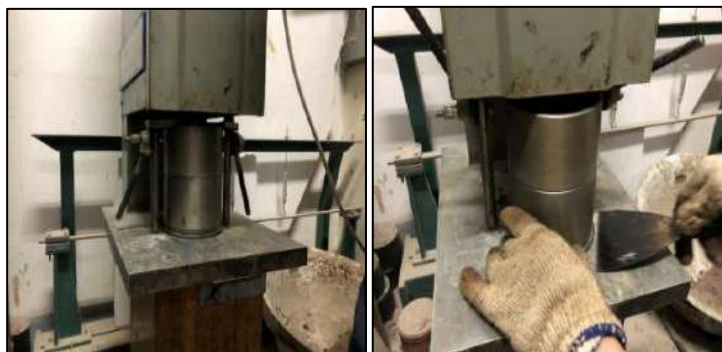
รูปที่ 2-19 ขั้นตอนการนำแบบ Mold เข้าเครื่องบดอัด Marshall compaction
