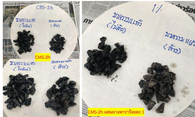
รูปที่ 2-41 ผลการทดสอบประสิทธิภาพการเคลือบหินและกันน้ำของ CMS-2h และ CMS-2h ผสมยางพารา
