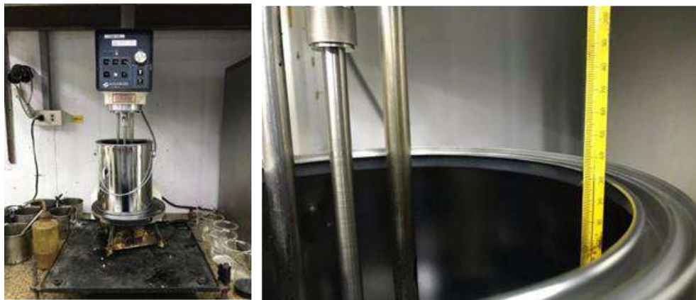
รูปที่ 2-11 การเตรียมตัวอย่าง Joint Sealant ด้วยเครื่อง High Shear
