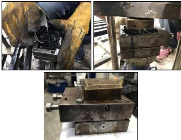
รูปที่ 2-31 ขั้นตอนการเตรียมตัวอย่างแอสฟัลต์คอนกรีต
