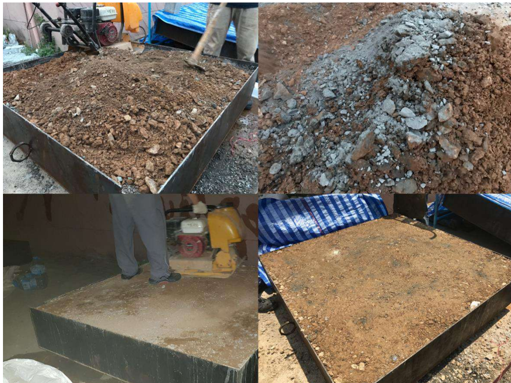
รูปที่ 2-64 การบดอัดดินซีเมนต์ผสมยางพาราในกระเบตสอบ
