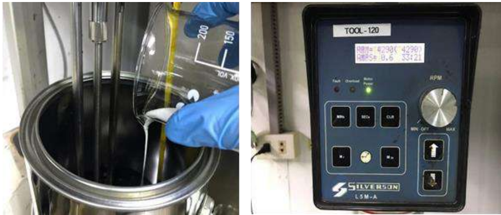
รูปที่ 2-12 การเทยางพาราลงผสมกับ Joint Sealant
