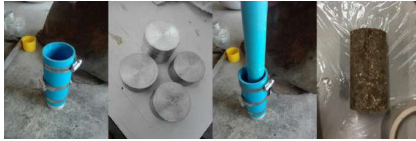
รูปที่ 2-35 แสดงภาพ Mould ที่ใช้ในการบดอัดและตัวอย่างดินหลังการบดอัด
