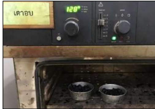
รูปที่ 2-27 นำตัวอย่างแอสฟัลต์คอนกรีตเข้าเตาอบ
