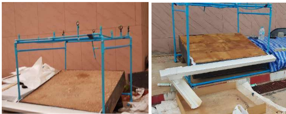
รูปที่ 2-69 การจำลองฝนตกในแปลงทดสอบ
