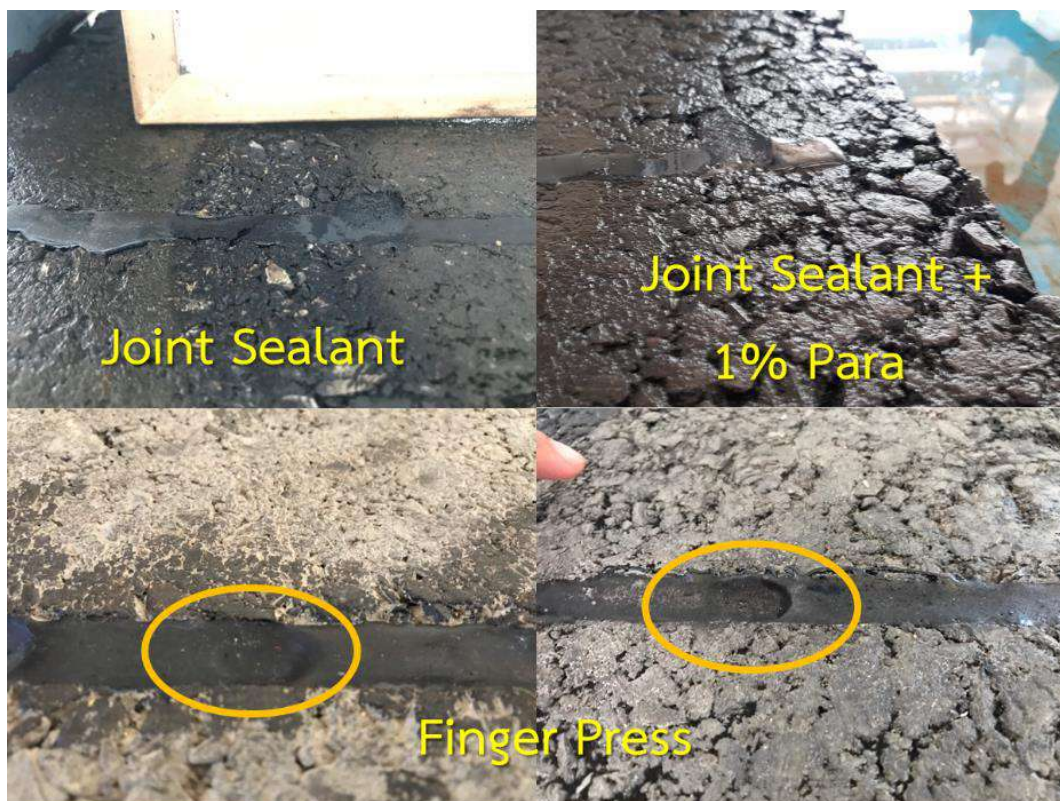
รูปที่ 3-3 ลักษณะพื้นผิวของวัสดุอุดซ่อมรอยแตกตาม ทล.ม. 328 และส่วนผสมที่มียางพาราร้อยละ 1 หลังจากจำลองสภาพการใช้งานด้วยเครื่อง Three-Wheel Polishing Machine
