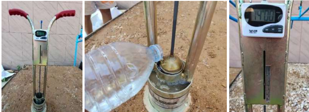
รูปที่ 2-72 ขั้นตอนการหาค่าสัมประสิทธิ์การซึมผ่านของน้ำที่ผิวดิน (Soil Surface Infiltration)
