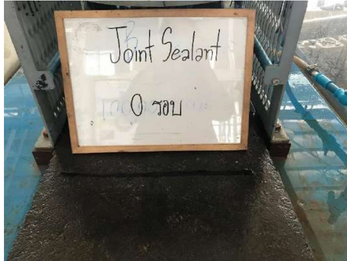
รูปที่ 2-61 ขั้นตอนการขัดแผ่นด้วยเครื่องทดสอบ Accelerated Polishing Machine for Asphalt Mixtures
