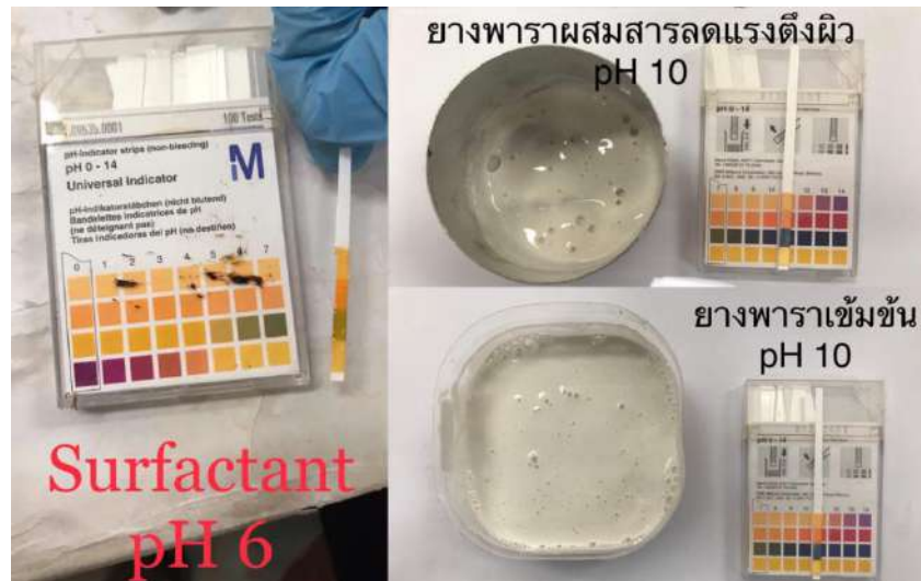
รูปที่ 2-43 การทดสอบ pH ของสารลดแรงตึงผิว ยางพาราเข้มข้น และยางพาราเข้มข้นผสมสารลดแรงตึงผิว
