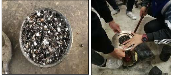
รูปที่ 2-20 ก้อนตัวอย่างหลังจากเข้าเครื่องบดอัด Marshall compaction
