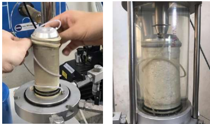
รูปที่ 2-37 ขั้นตอนการเตรียมตัวอย่างสำหรับการทดสอบ UU Triaxial Test
