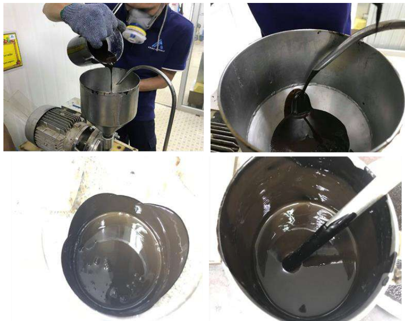
รูปที่ 2-8 นำส่วนผสมแอสฟัลต์อิมัลชันและยางพารา ลงป่นด้วยเครื่อง Colloid Mill Machine
