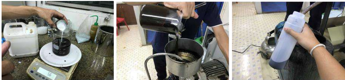
รูปที่ 2-10 ผสม CSS-1 กับน้ำยางพาราเข้มข้น ด้วยเครื่อง Colloid Mill Machine
