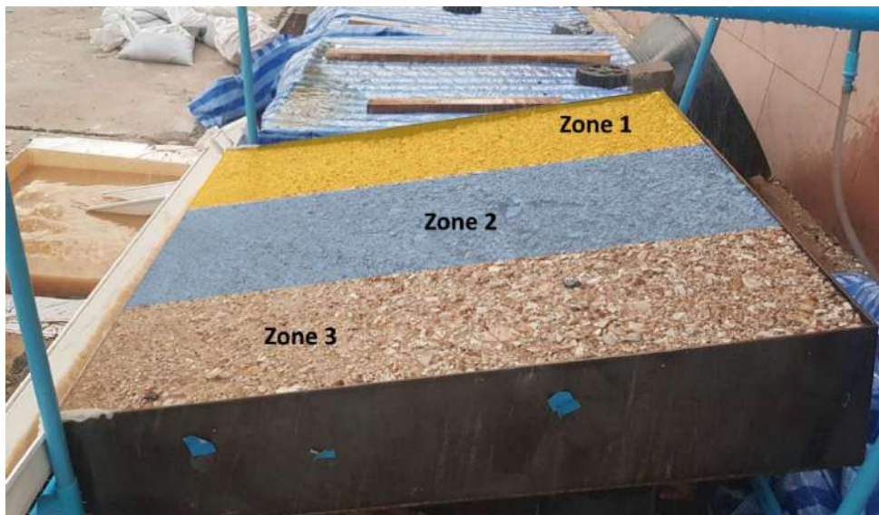
รูปที่ 2-73 การเลือกตำแหน่งการทดสอบ Surface Infiltration ต่อ 1 กระเบ
