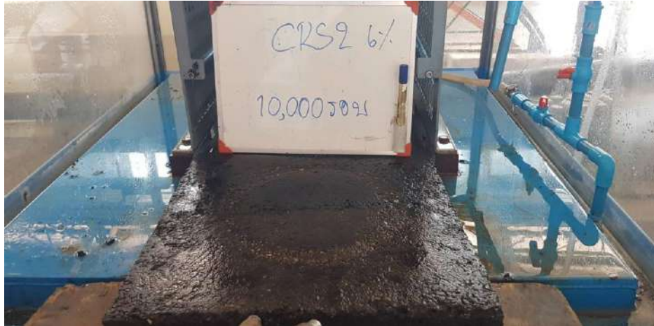
รูปที่ 2-57 ขั้นตอนการขัดแผ่นด้วยเครื่องทดสอบ Accelerated Polishing Machine for Asphalt Mixtures
