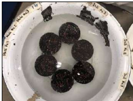
รูปที่ 2-21 ขั้นตอนการนำก้อนตัวอย่างแช่ในอ่างปรับอุณหภูมิ (water bath) ที่ 25 \pm 1 องศาเซลเซียส เป็นเวลา 1 ชั่วโมง
