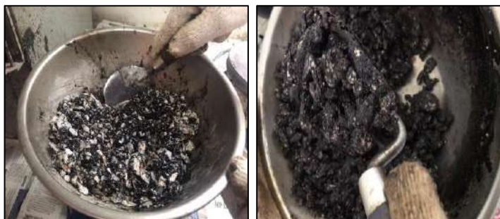
รูปที่ 2-17 การเตรียมวัสดุมวลรวม กับวัสดุเชื่อมประสานเข้าด้วยกัน
