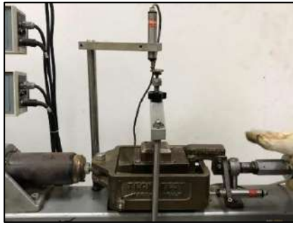
รูปที่ 2-32 ขั้นตอนการติดตั้งอุปกรณ์การทดสอบ Direct Shear
