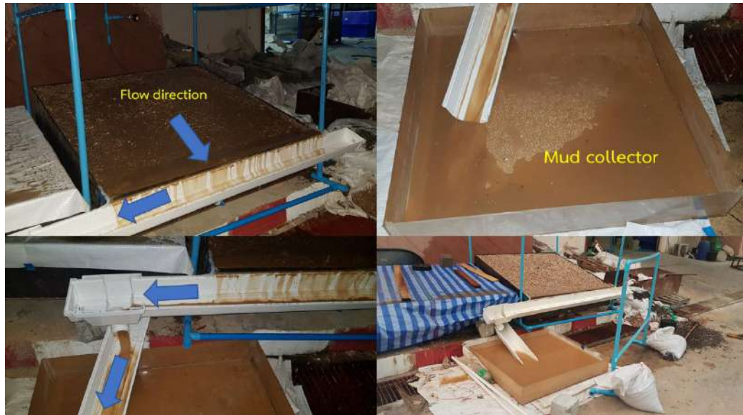
รูปที่ 2-70 การทดสอบประสิทธิภาพการป้องกันการชะล้างพังทลายของลาดดิน
